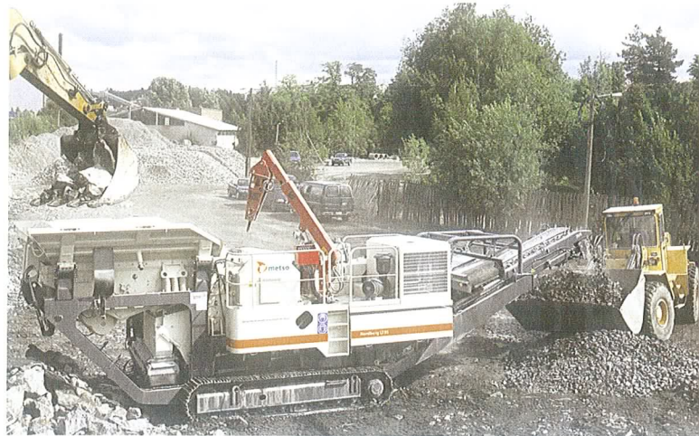
Le LT95 dispose d'un automate intelligent, le Nordberg IC500, qui contrôle et ajuste tous les principaux paramètres du processus de concassage.
