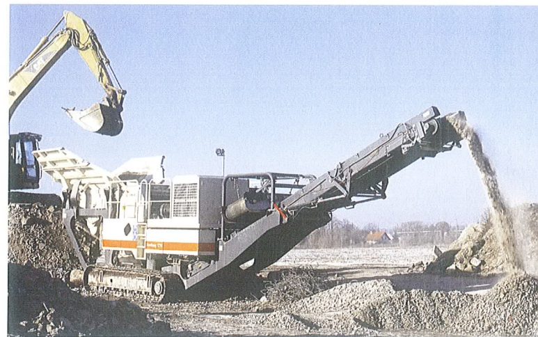
Le transporteur principal rallongé peut être équipé en option d'un séparateur magnétique pour les applications de recyclage.
